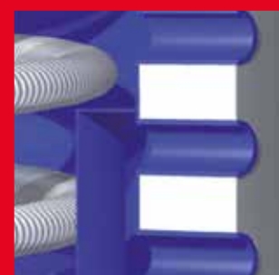
Vaporizadores de corrente de entrada impedem a mistura da camada de 2 zonas no acumulador
